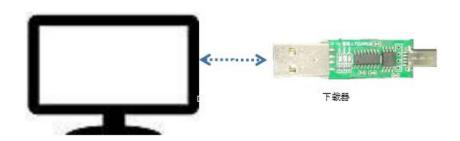
1: 下载器连接电脑,将准备好的BIN文档语音拷贝到下载器中。
