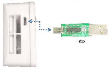
2: 下载器插入产品产品micro接口,自动进行拷贝,拷贝时指示灯快闪,拷贝完快闪灯熄灭,拷贝完成灯常亮。
